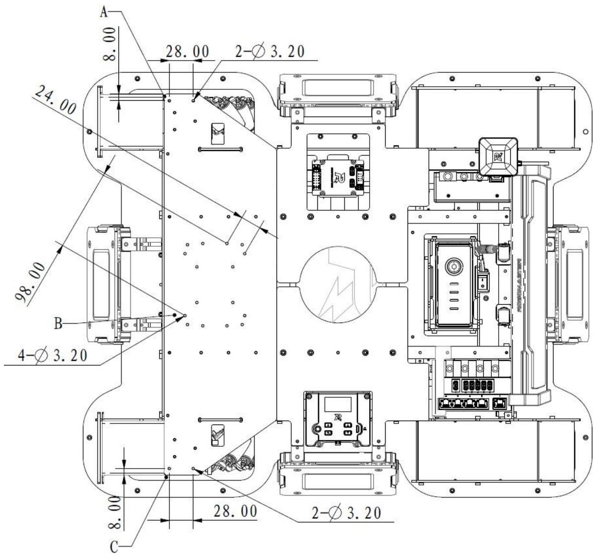
A : 右侧传感器安装支架固定孔      B : 前部传感器安装支架固定孔      C : 左侧传感器安装支架固定孔
