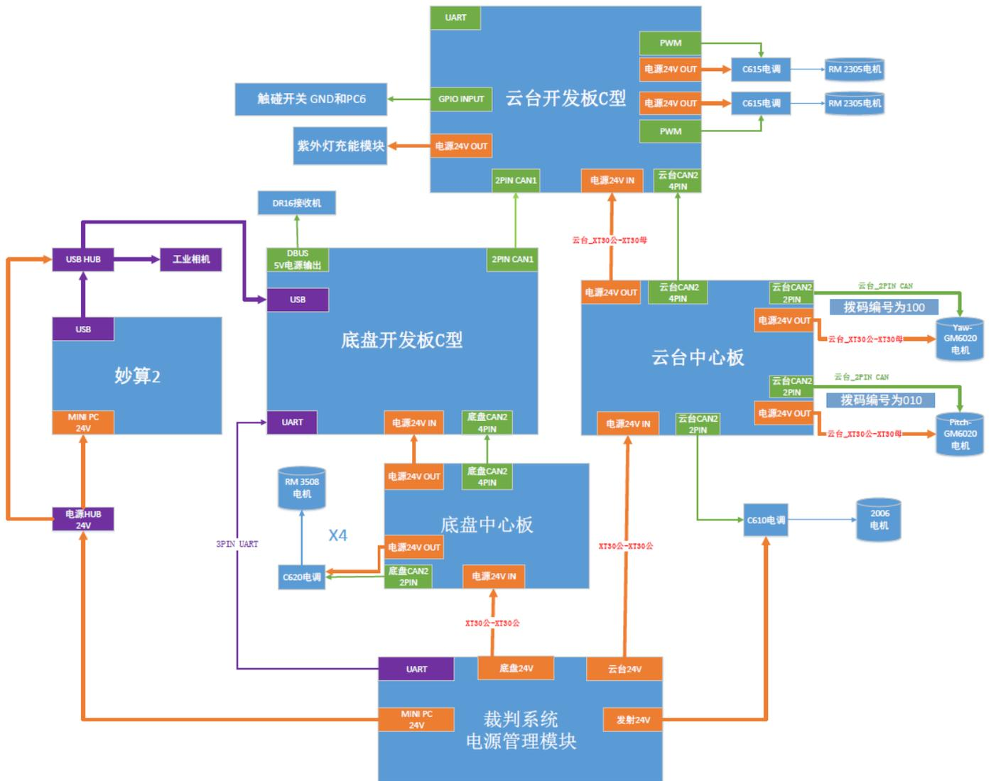
RoboMaster 开发板 C 型是专为 RoboMaster 机器人而设计的开源主控板，满足整个机器人控制需求，并且提供开放接口，方便用户自定义机器人系统开发其他功能。RoboMaster 开发板 C 型的详细技术资料参考附件包中《RoboMaster 开发板 C 型 使用说明》或登陆 <https://robomaster.com> 下载相关资料。
