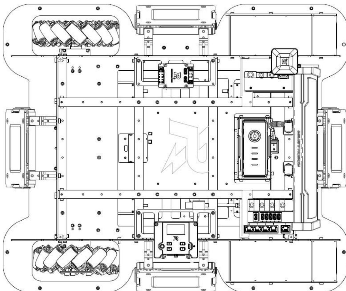
底盘模块使用 RoboMaster M3508 减速直流电机进行四轮驱动，电机调技术参数参考附件包中《RoboMaster M3508直流无刷减速电机使用说明》和《RoboMaster C620无刷电机调速器使用说明》。
