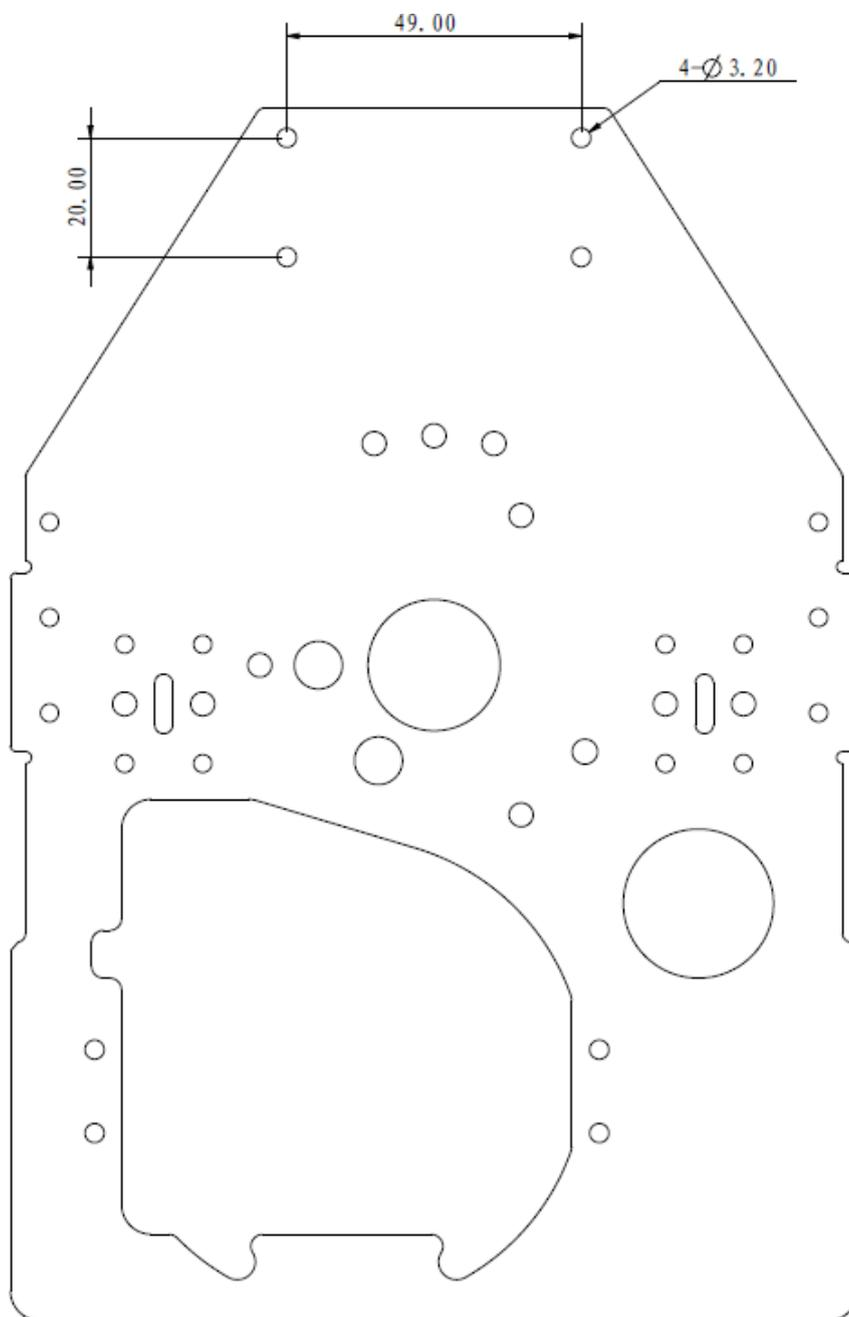
在底盘侧面（装甲板上方）和底盘前部均预留了传感器固定架的安装孔，可以根据以下安装孔设计安装支架。
